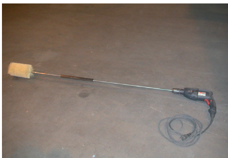
2. Montera roterande sotviska på skaftet och sedan på bormaskinen.
